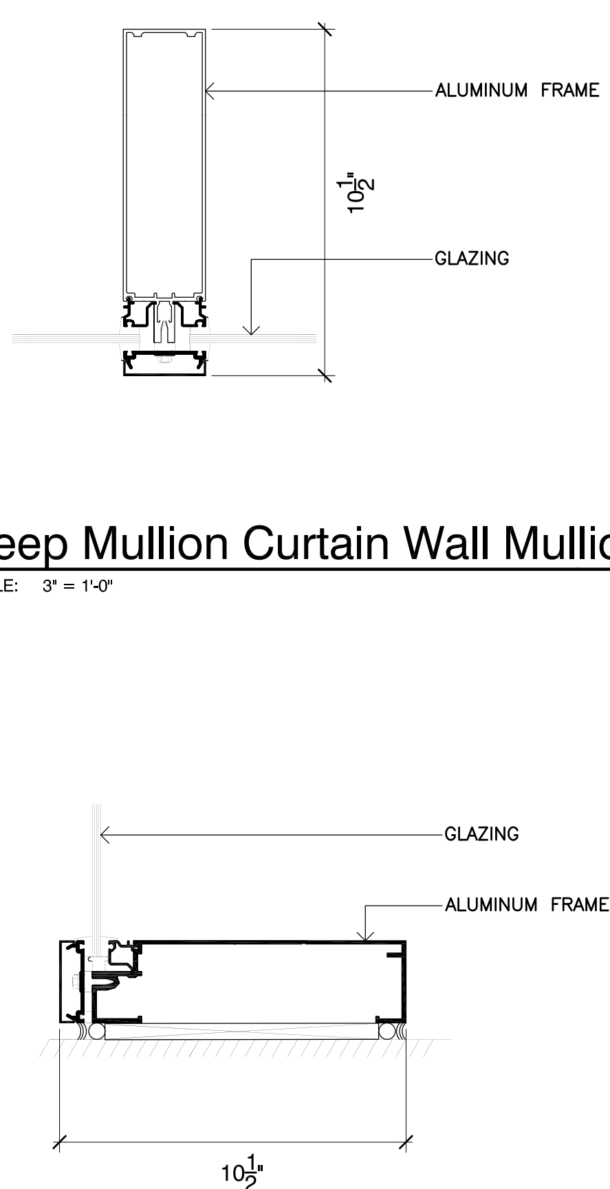
17 Deep Mullion Curtain Wall Sill SCALE: 3" = 1'-0"
